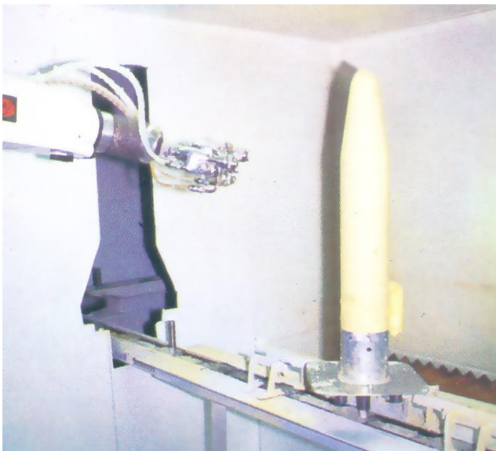
Рис. 4. Нанесення антикорозійного поліуретанового покриття на боєголовку ракети Sidewinder роботизованим пристроєм TR-3500 фірми DeVilbiss на базі ВПС США Хілл (штат Юта, США)
