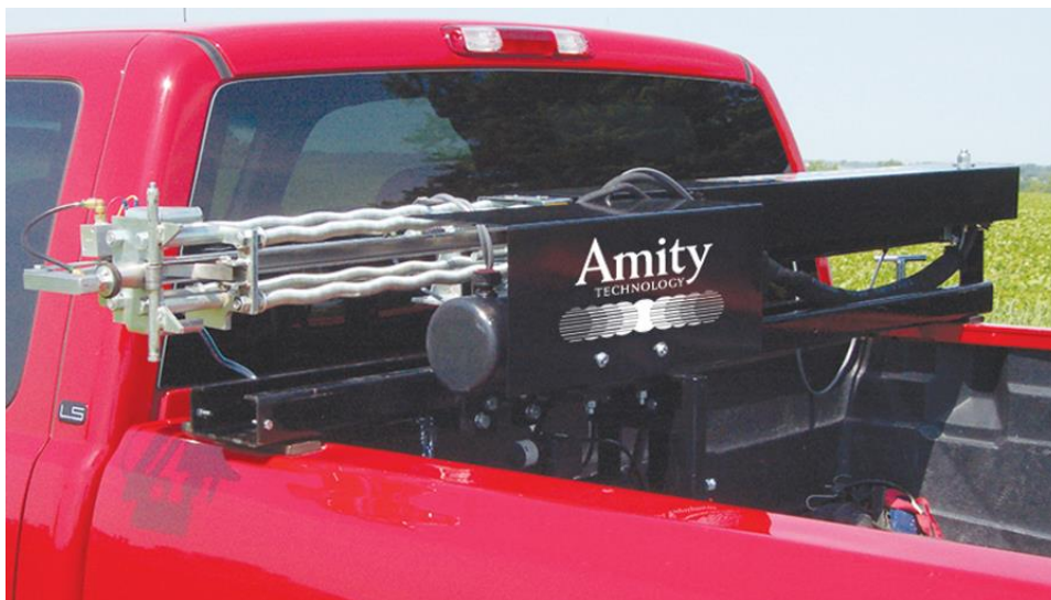
Рис. 2. Автоматичний грунтозабірник свердлильного типу Amity A2450.
