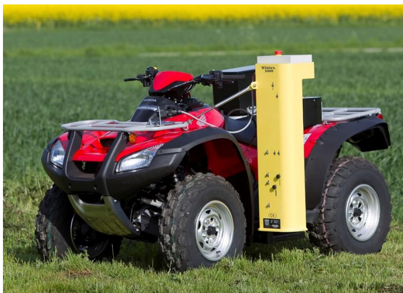
Рис. 3. Автоматичний грунтозабірник свердлильного типу Wintex 1000
