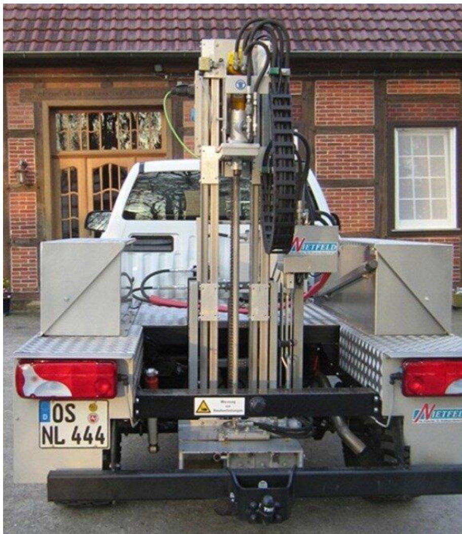
Рис. 4. Автоматичний ґрунтозабірник ударного типу Multiprob 120 UP
