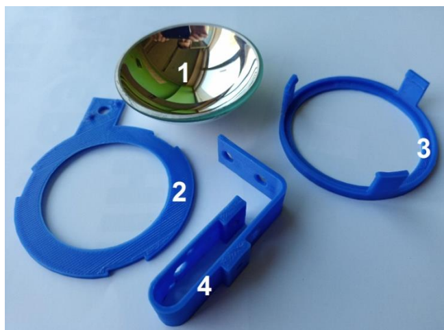
Рис. 4. Надруковані деталі вузла юстирування: 1 – сферичне дзеркало; 2 – основа; 3 – оправа; 4 – пружний кронштейн
