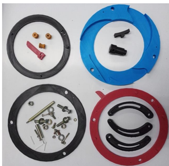
Рис. 3. Роздруковані на 3D-принтері деталі самоцентрованого пристрою та кріпильні деталі для складання
