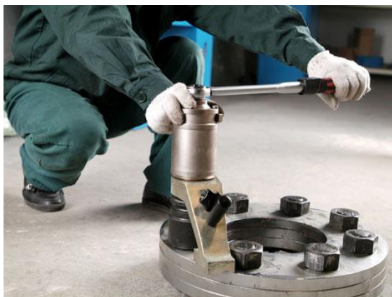
Рис 2. Використання мультиплікатора крутного моменту в парі з динамометричним ключем [2]
