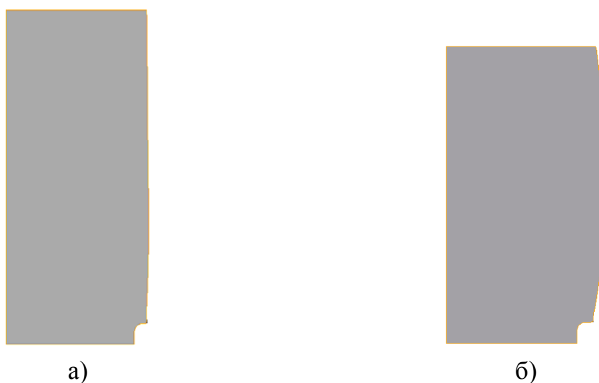
Рис. 4. Форма заготовки при 20% деформации с УЗ нагрузкой (а) и при дальнейшей деформации (до 30%), но уже без УЗ колебаний (б).
