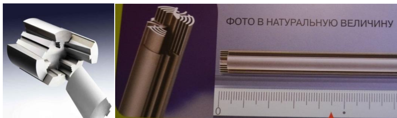
Рис.2. Виготовлення пуансонів із нержавіючої сталі (точність в межах \pm 4 мкм, а шорсткість R_a=0,4 мкм)
