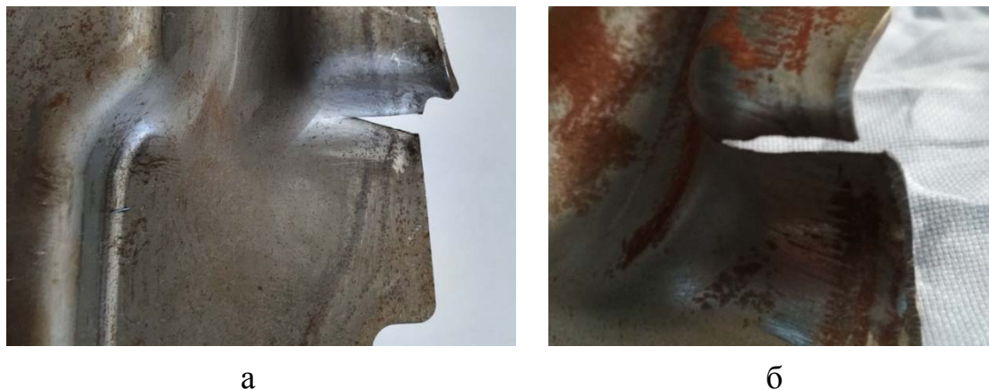
Рис. 1. Характер руйнування вихідної заготовки при деформуванні: а) за початкової геометрії; б) за скорегованої геометрії
