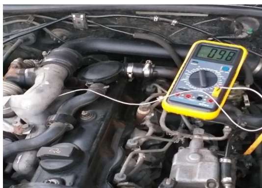
Рис. 4. Елементи Пельтьє на повітряному шлангу турбіни ТНА
