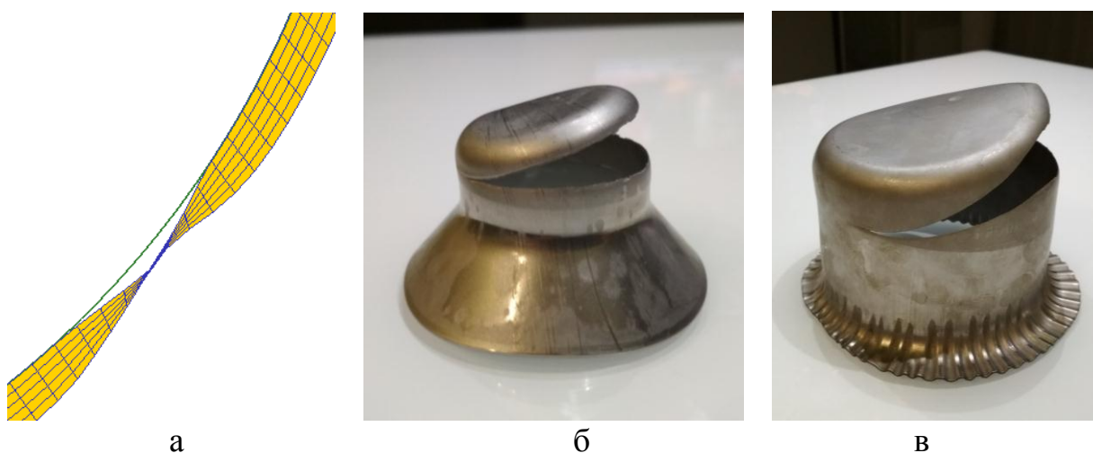
Рис. 1. Руйнування листового матеріалу при витягуванні:
