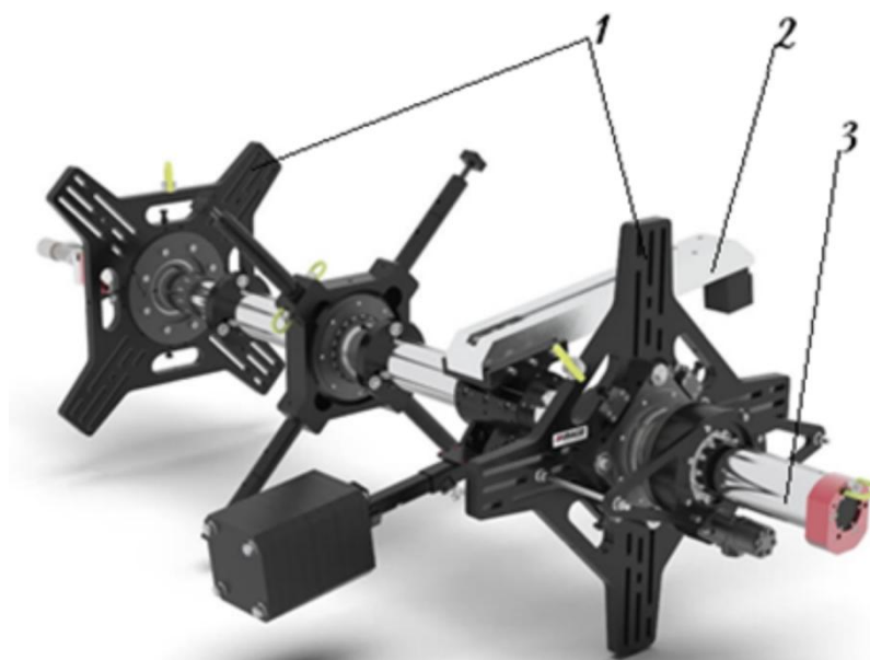
Рис. 1. Обладнання MIRAGE MACHINES MLB915: загальний вигляд. Позначено: 1– планшайби; 2–каретка з різцем; 3–борштанга.
