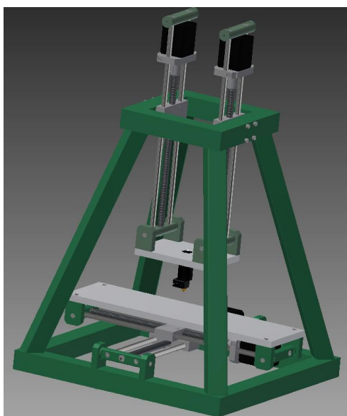
Рис. 7. Розроблена компоновка 3Dпринера
