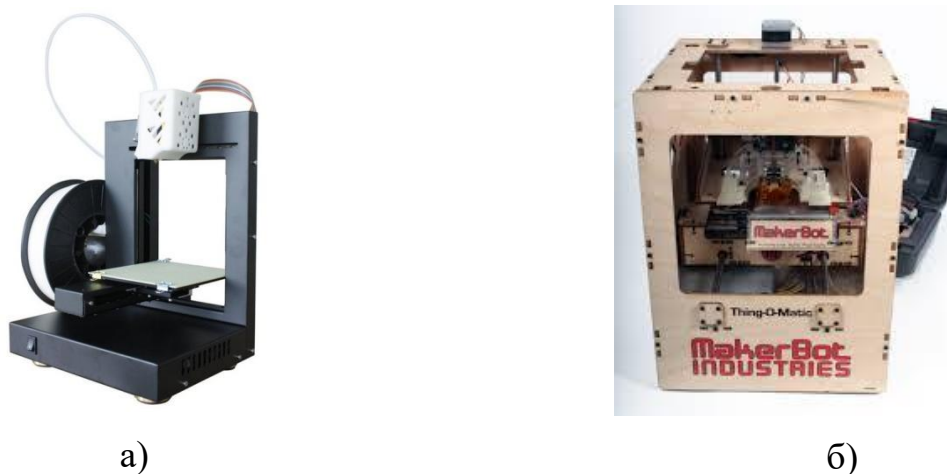
Рис. 1. Зовнішній вигляд 3D принтера, де стіл має 2 ступені вільності: а) –принтер "UP!"; б) – принтер "Thing-O-Matic"
