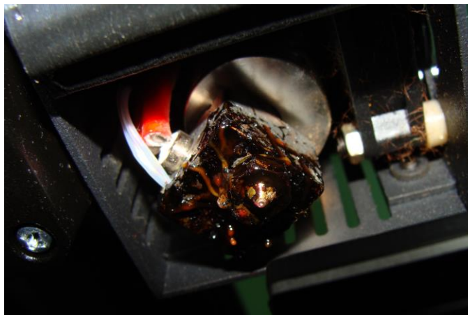
Рис. 4. Вигляд хотенду екструдера після тривалого використання
