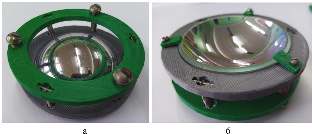
Рис. 3. Вид пристрою юстирування з боку: а) юстирувальних елементів; б) дзеркала сферичного
