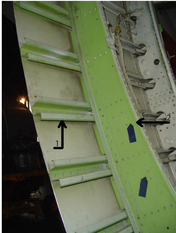
Рис. 1. Частина корпусу літака зі стрингером (1) та нервюрою (2)
