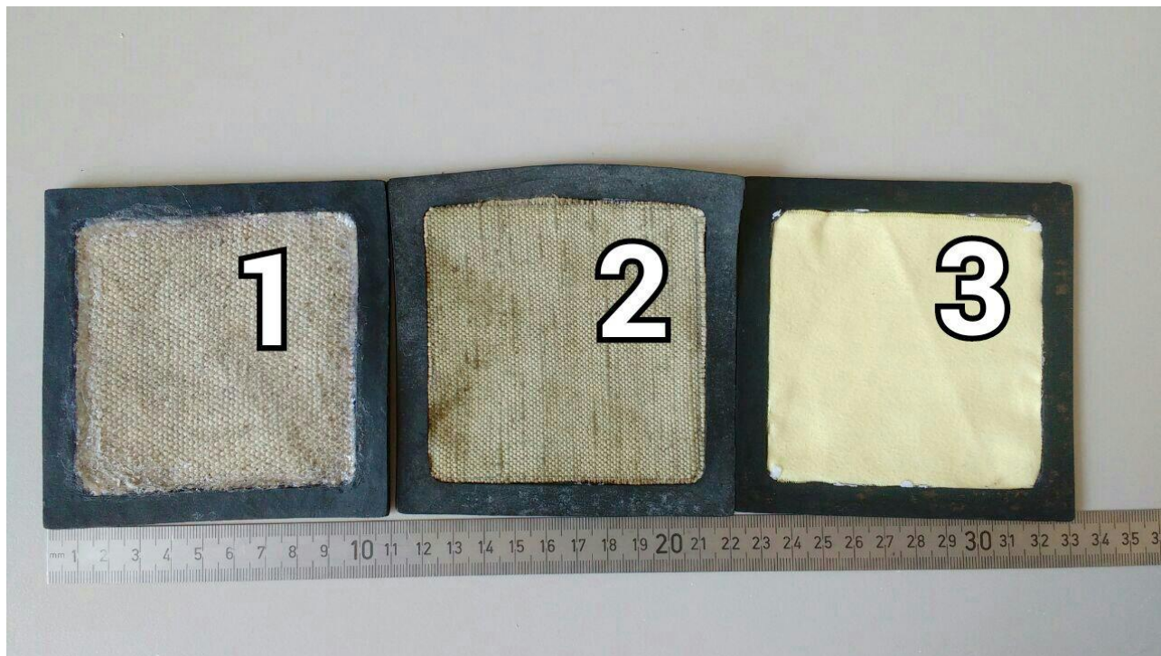
Рис.3. Зразки перегородок (1- азбестова тканина, 2- брезент, 3- штучна замша)
