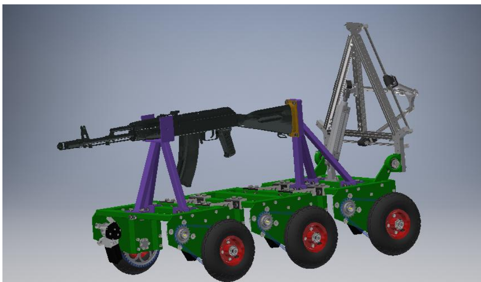
Рис.1. Модульний роботизований комплекс спеціального призначення, який включає в себе 3 колісні модулі
