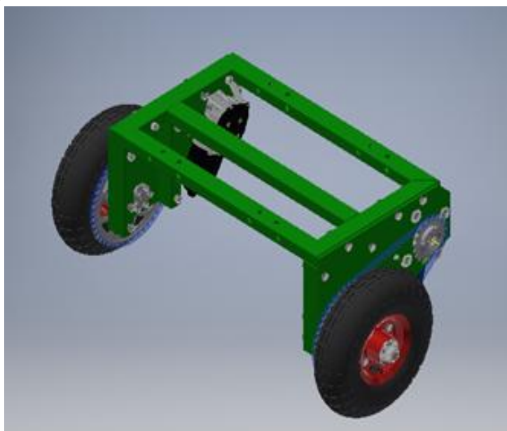
Рис.1. Колісний модуль наземного роботизованого комплексу спеціального призначення
