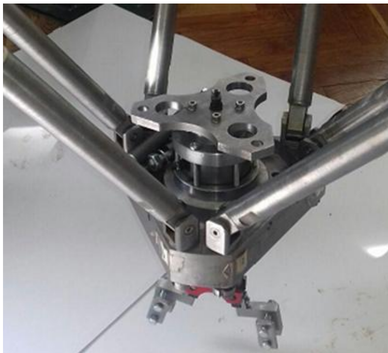
Рис. 3 Штанги мобільного роботизованого комплексу
