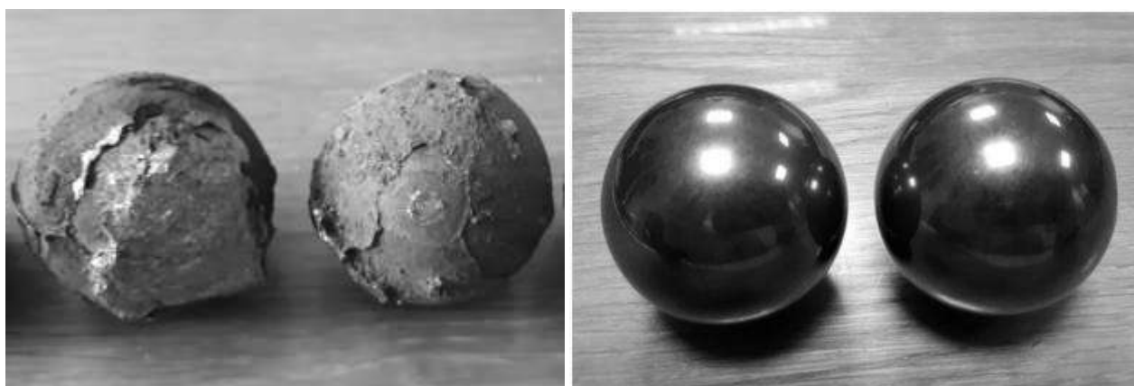
Рис. 1. Вигляд керамічних заготовок після спікання (а) й готових куль з карбіду кремнію (б) [3]
