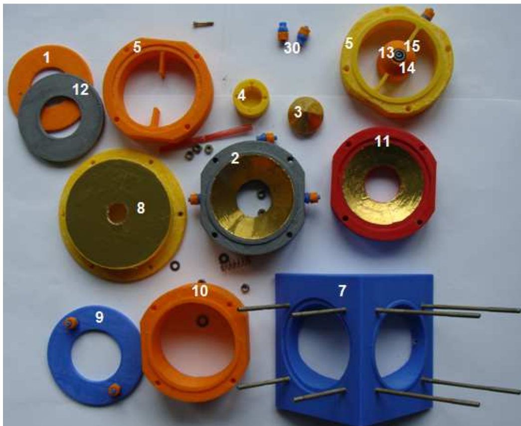
Рис. 3. Деталі, які входять у склад конструкції оптичної системи концентрації лазерного проміння на поверхні обробленої заготовки (числові позначення згідно рис. 1)
