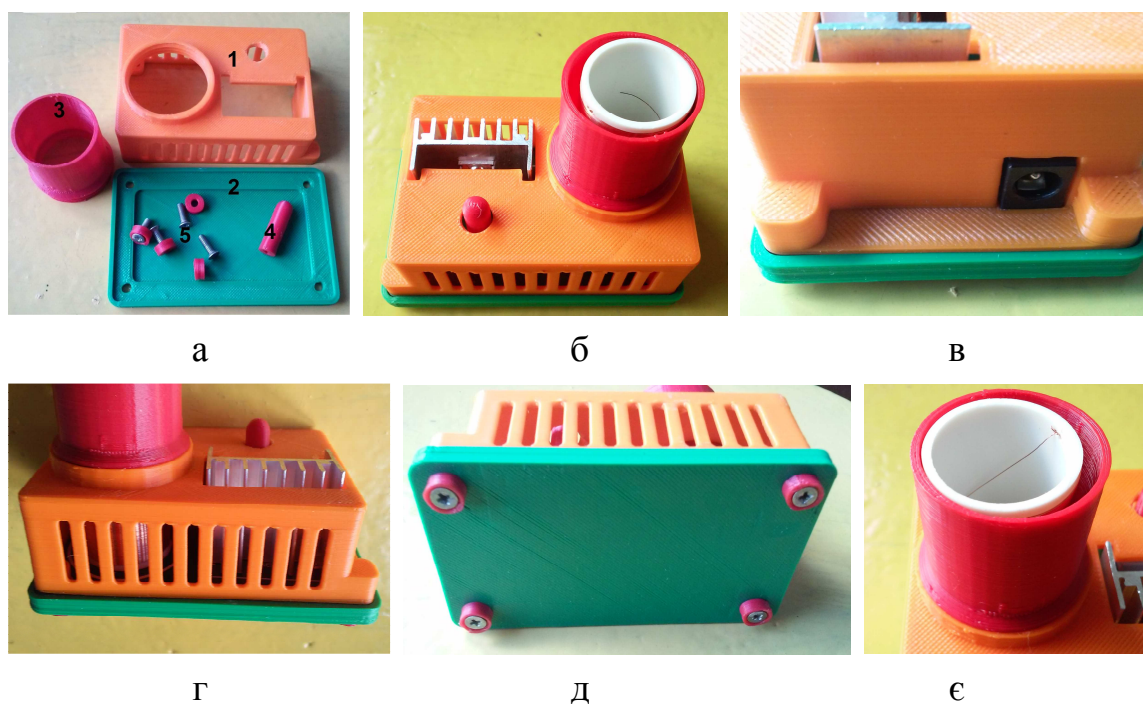
Рис. 2. Конструювання пристрою для передачі електроенергії на відстані: а) надруковані на 3D-принтері елементи корпусу; б) пристрій складений; в) роз'єм для джерела живлення; г) вентиляційні отвори; д) опорні ніжки; є) захисний тубус
