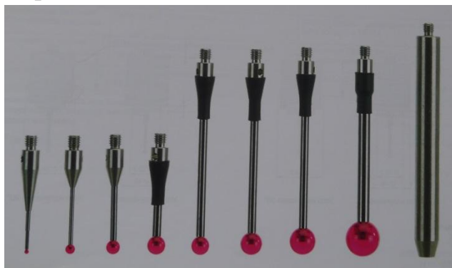
Рис. 5. Вимірювальні стержні з рубіновими кульками.
