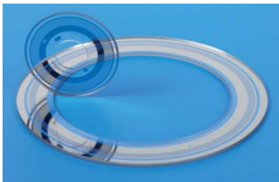
Рис. 3. Градуйовані диски інкрементальних датчиків обертання
