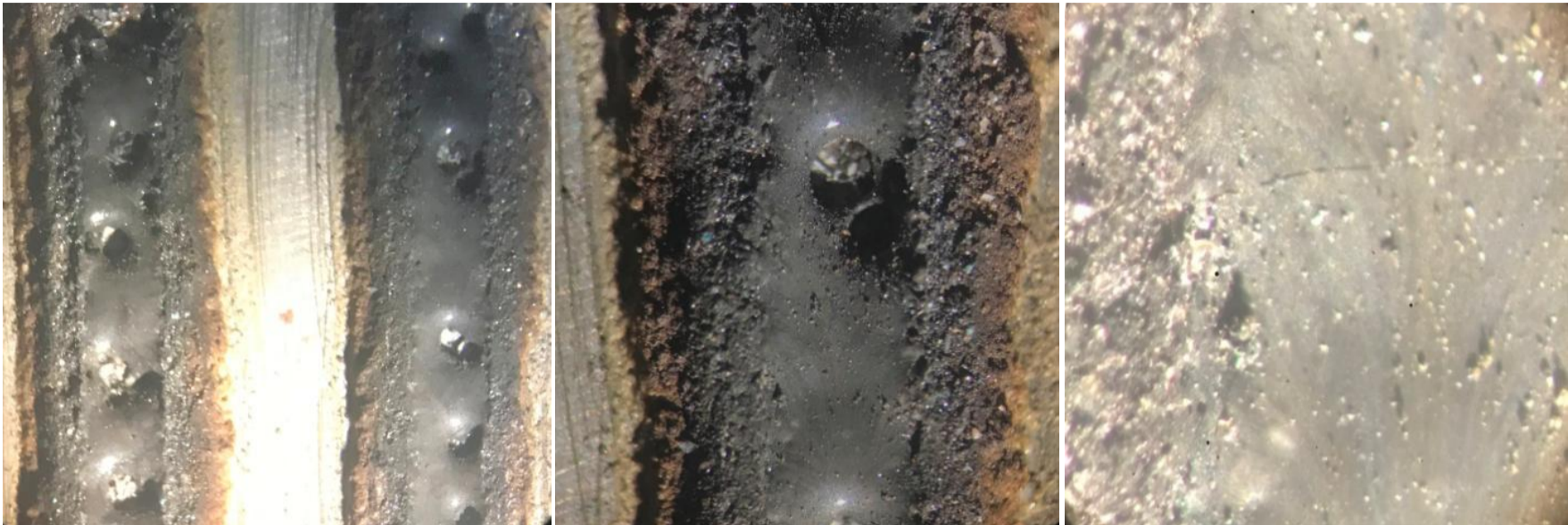
Рис.3 Загальний вид отриманого покриття при різному збільшені (швидкість обробки 1,2 м/хв): а – х20; б – х50 ; в – х100
