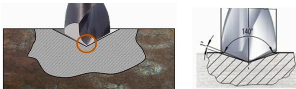
Рис.2. Схема направлення свердла при центруванні свердлом з кутом при вершині 2\varphi , що більший ніж у робочого свердла
