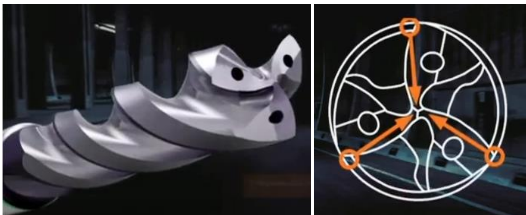
Рис.3. Геометрія різальної частини трьохзубого свердла
