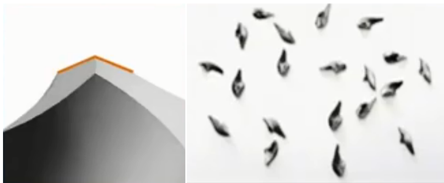
Рис.4. Пірамідальна вершина та елементи подрібненої стружки
