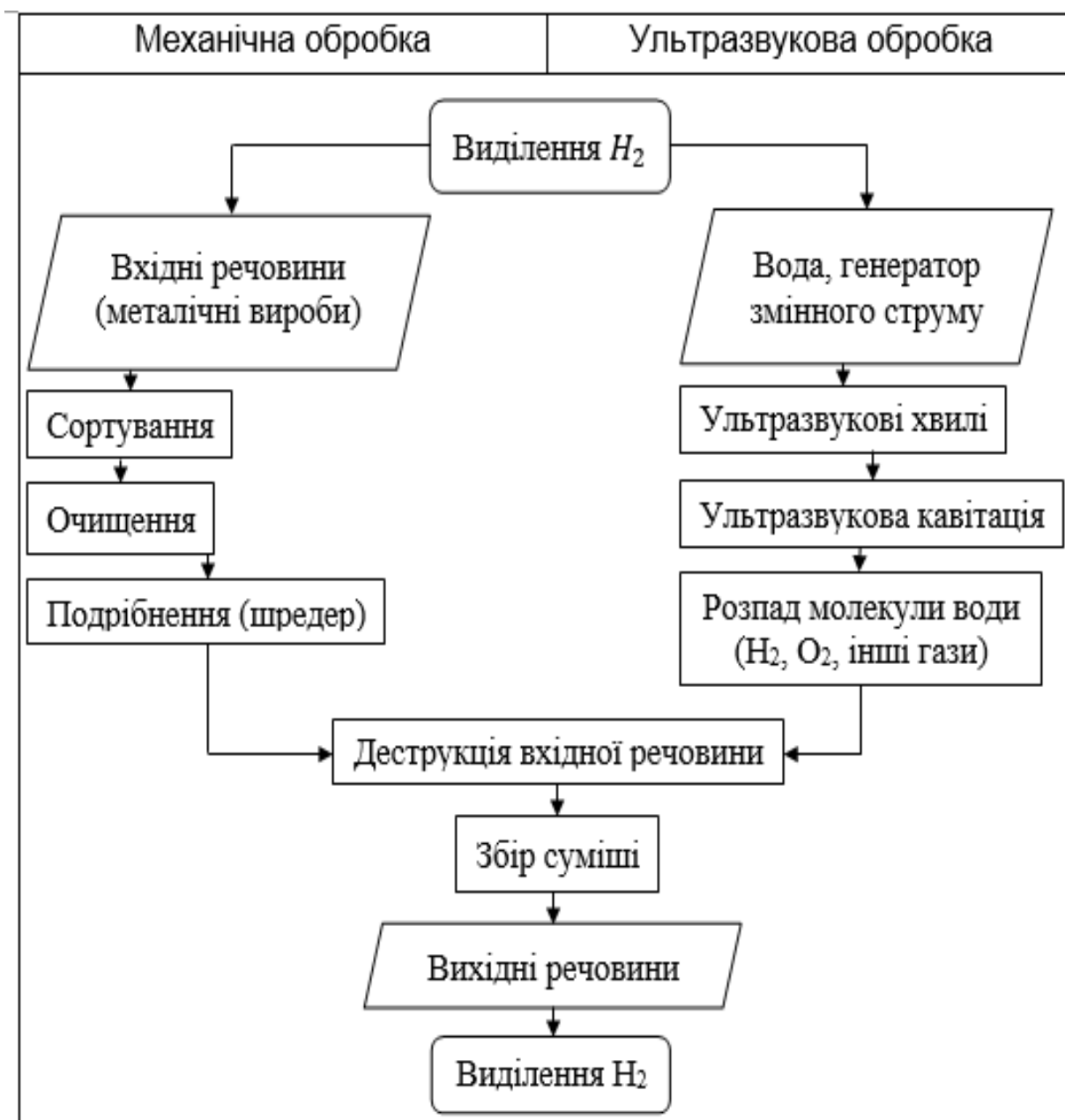
Рис. 1. Схема процесу утворення водню з відходів, що проходять подвійну обробку – механічну й ультразвукову
